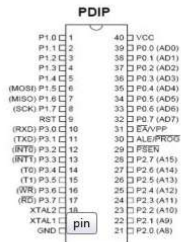
Gambar 3.1. Konfigurasi Pin AT89S51
