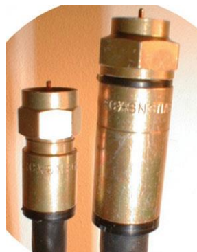
Gambar II.19 Kabel Coaxial sebagai IFL
