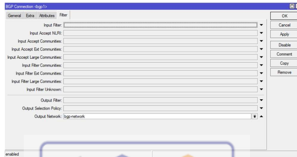
Fig 31. Konfigurasi Connection BGP pada router distribution 3
