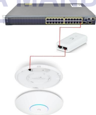
Gambar IV. 7 Skema Pemasangan Access Point Unifi U6 Lite
