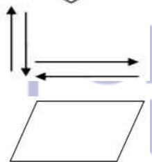
Flow Line : Digunakan untuk menggambarkan hubungan proses dari suatu proses ke proses lainnya
