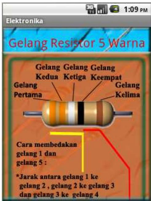
Ketika menekan button resistor gelang 5 warna resistor maka akan muncul cara membaca resistor dengan 5 gelang warna.
