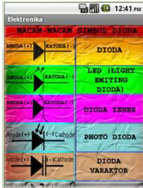
Ketika menekan Button Macam-macam symbol diode maka akan muncul layer atau tampilan yang sering digunakan untuk menggambarkan jenis komponen dioda
