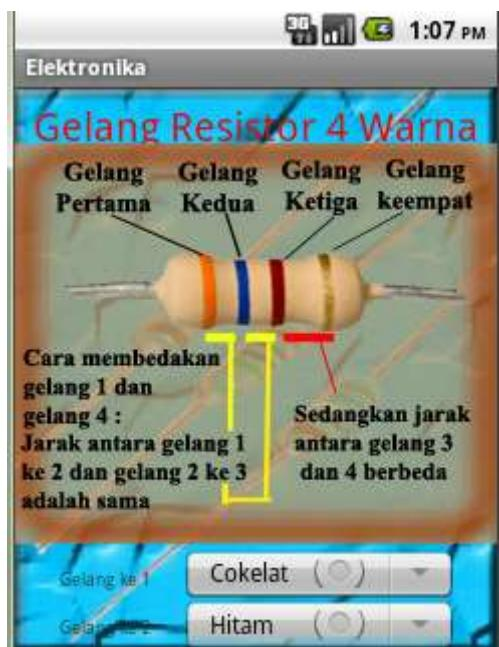
Ketika menekan button resistor gelang 4 warna resistor maka akan muncul kalkulator perhitungan nilai resistansi dari sebuah resistor.
