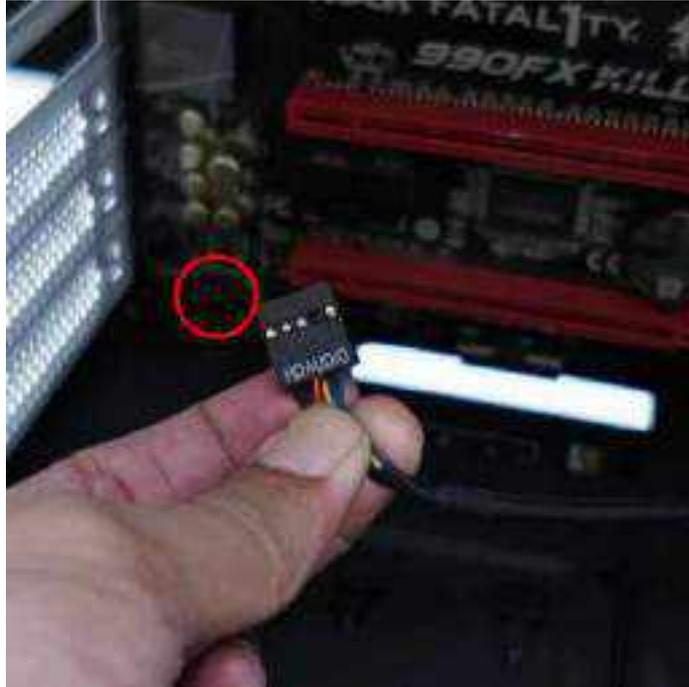
Gambar 53. Menghubungkan kabel audio ke motherboard
