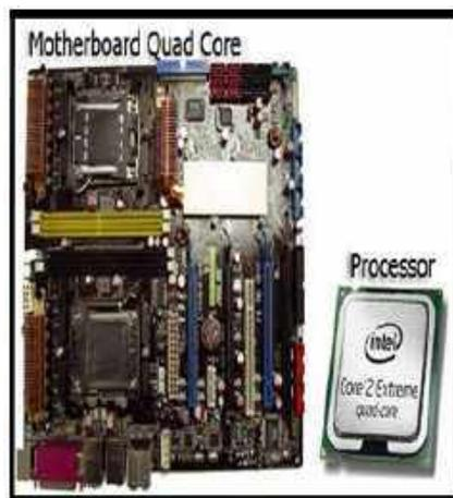
Gambar 24. Motherboard dan prosesor Quad Core
