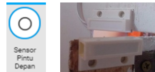
Gambar Reed Switch dan Magnet Terpisah dan indikator sensor Off
