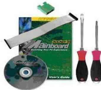
Buku manual diperlukan sebagai rujukan untuk mengetahui diagram posisi dari elemen koneksi (konektor, port dan slot) dan elemen konfigurasi (jumper dan switch) beserta cara setting jumper dan switch yang sesuai untuk komputer yang dirakit. Diskette atau CD Software diperlukan untuk menginstall Sistem Operasi, device driver dari piranti, dan program aplikasi pada komputer yang selesai dirakit.
