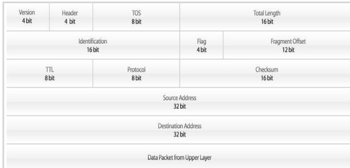
Gambar 4.3 : Struktur Paket IPv4
