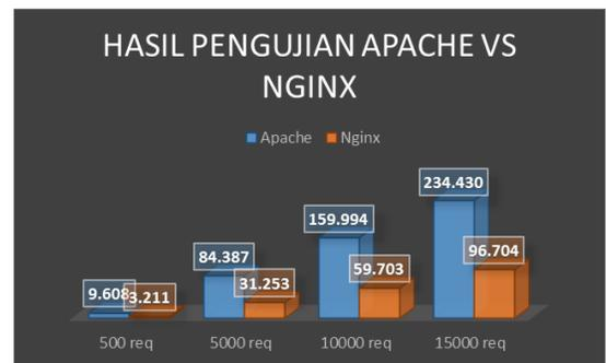
Gambar 10. Grafik hasil pengujian Apache dan Nginx
